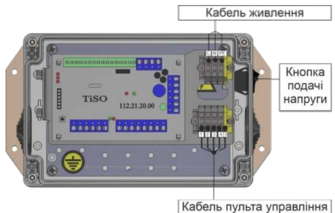
Рис.24 – Блок електронного керування – підключення турнікету
