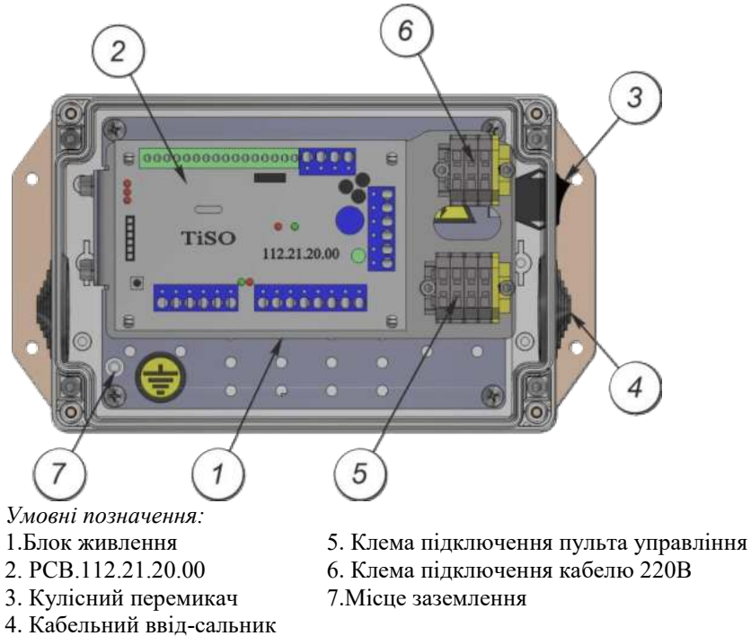
Рис.4 – Конструкція та умовні позначення блоку електронного управління
