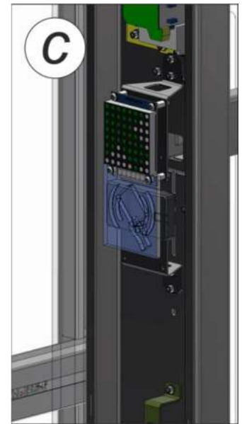
Рис.26 – Підключення кабелю зв'язку з пультом керування
