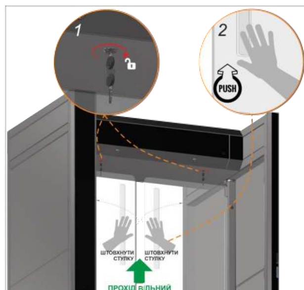
Рис.29 - Створення вільного проходу при вимкненому живлення (функції fail secure)
