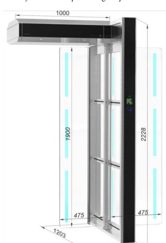
Рис.3– Габаритні розміри тумби турнікета
