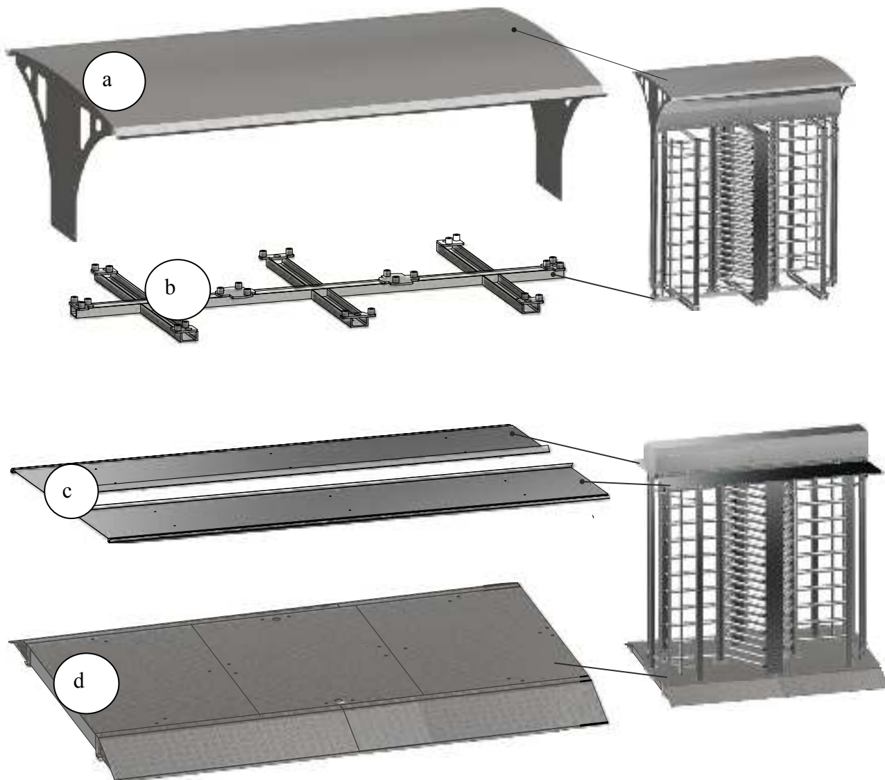
Рис.13– Використання додаткових елементів конструкції турнікета «SESAME TWIN-L»
