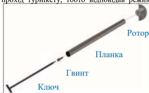
Рис.9— Складання основних елементів та встановлення планок турнікету
