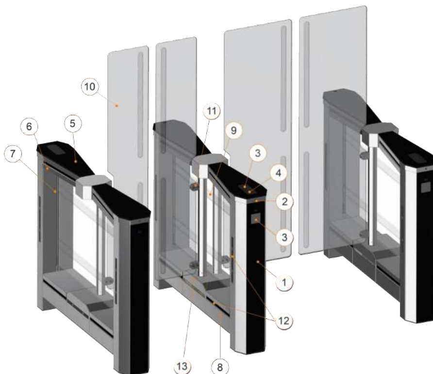
Рис.5 – Конструкція турнікету «Sweeper-WP-HG-2» ТЗ.КCD.XD.X в складі турнікету «Sweeper-WP-HG-1»
