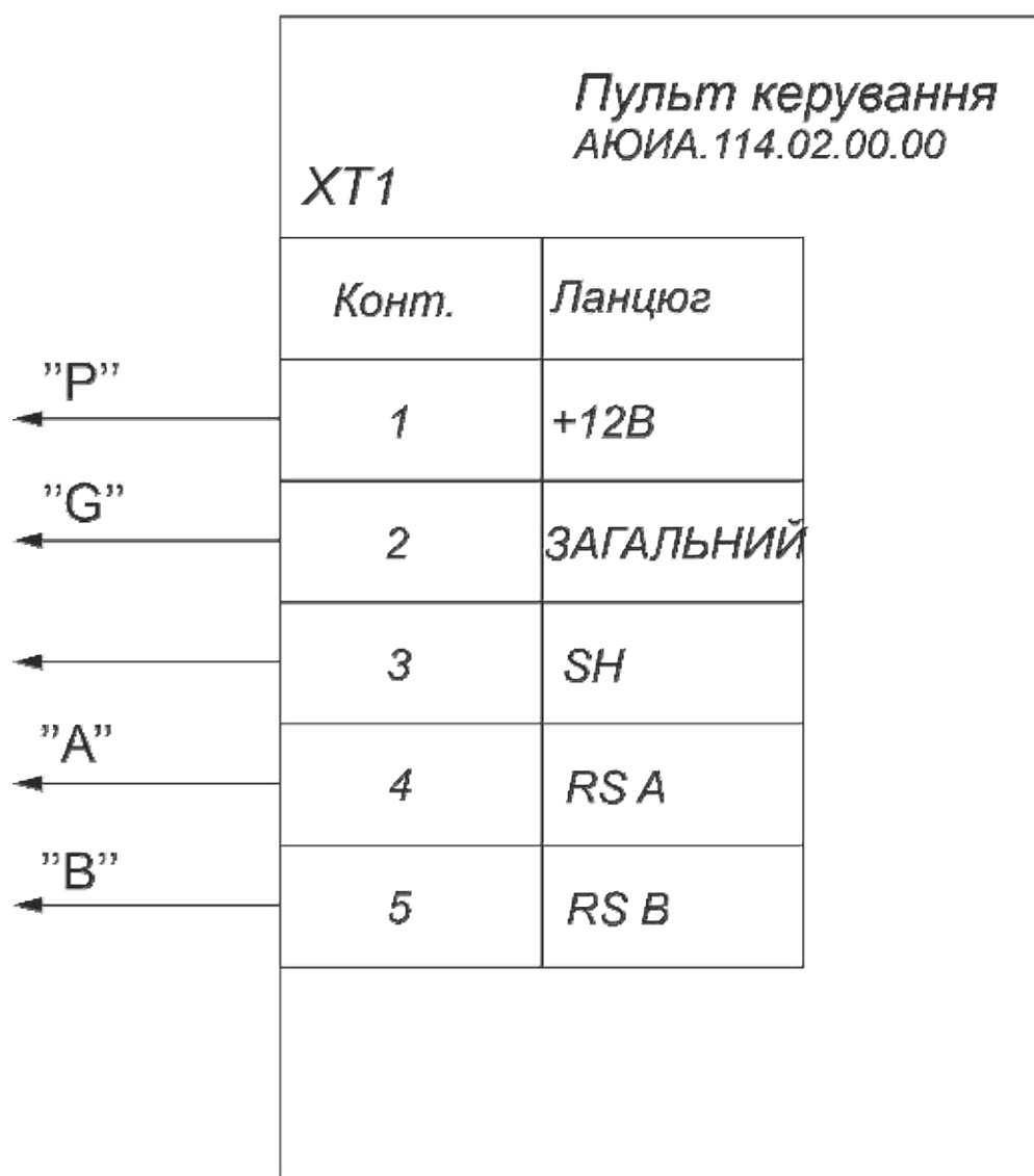
Рисунок Б.2 – Схема електрична підключення пульта керування АЮІА.114.02.00.00
