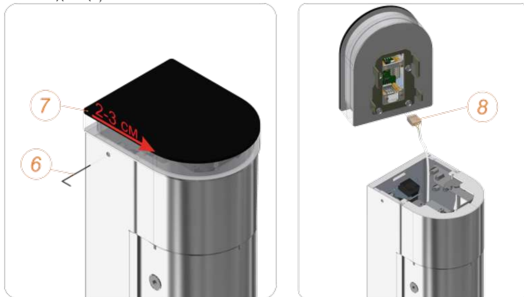
Рис.18 – Встановлення кришки на стійку турнікету
