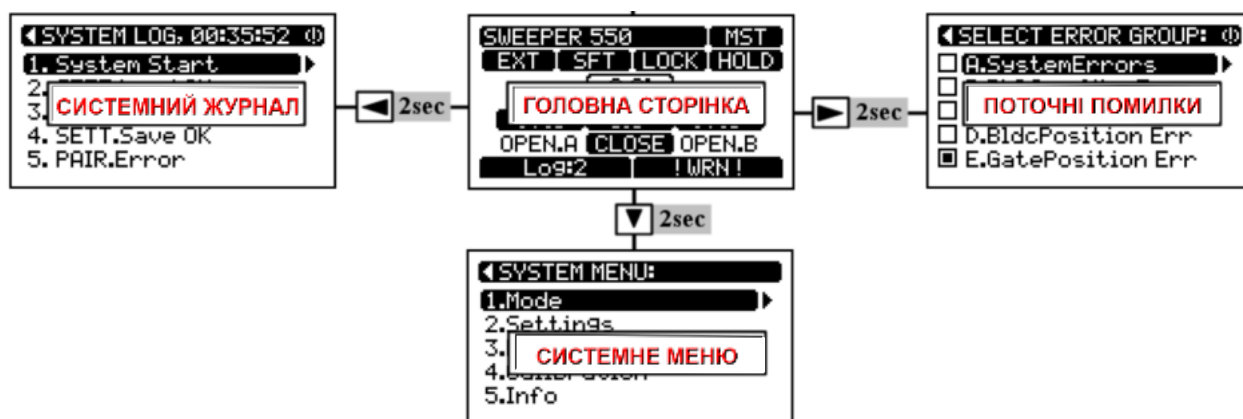
Рис.14 – Перехід до інших сторінок (функцій) меню на OLED
