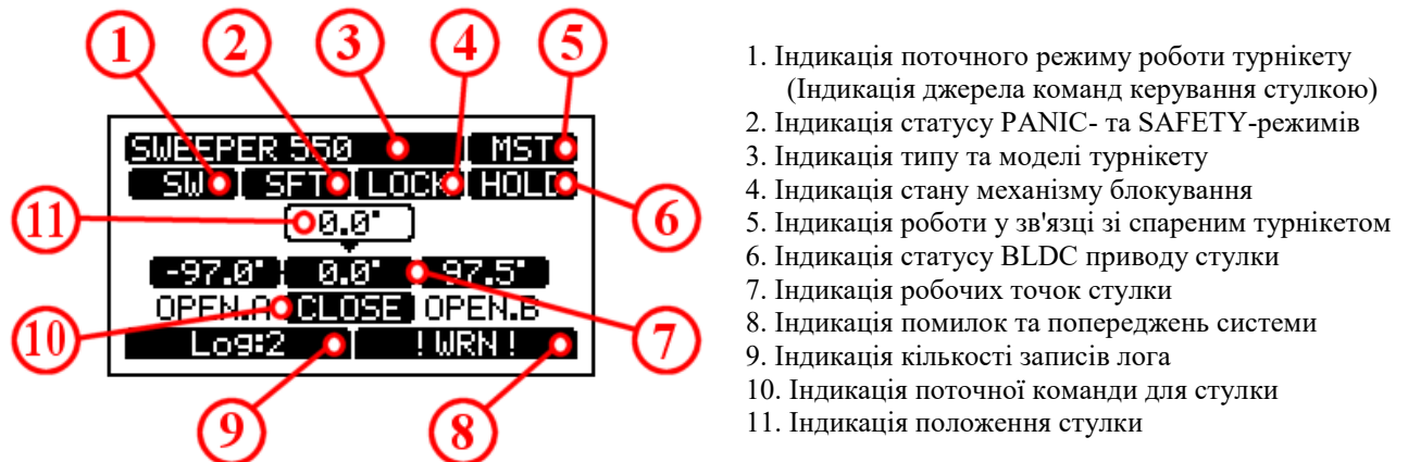
Рис.12 – Структура головної сторінки на дисплеї контролера
